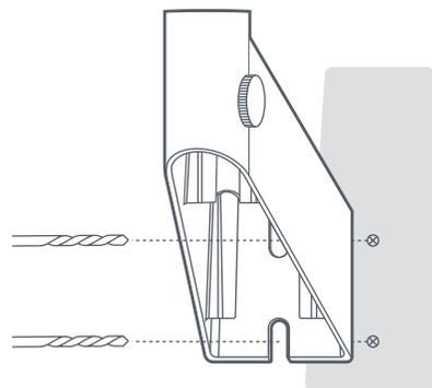
**7 | Aplique o selante e parafuse o suporte na parede**
