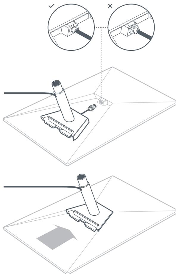
**11 | Inserte el equipo Starlink en el soporte de pared**
