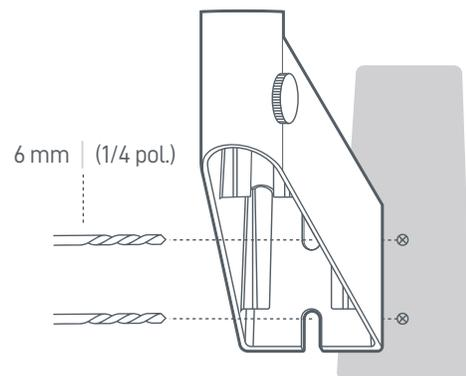
**7 | Aplique o selante e aparafuse o suporte de parede**
