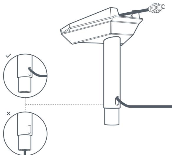
**10 | Conecte o cabo e instale a haste**
